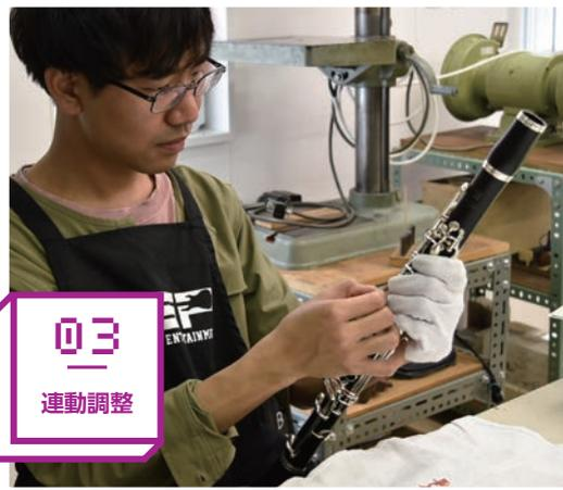
キィの開き具合や閉じるタイミングなど、木管楽器が音を出すために必要な部分を調整して、より演奏しやすい楽器へ仕上げる調整。キィについているコルクやフェルトの厚みを変えたり、時にはキィを曲げたりして快適に演奏できる楽器に仕上げます。
