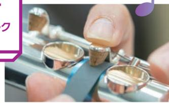
キィコルクは操作時のノイズを防いだり、操作性や音程などの吹奏感にも影響するキィの開き具合を決める役割を担っています。カミソリやヤスリを使って最適になるように、細かく調整していく作業です。もちろん見た目も重要なので、美しく仕上げられるように練習します。
