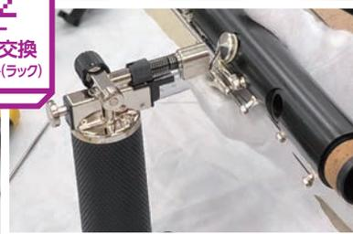
クラリネットのタンポは熱すると溶け、冷めると固まる性質を持った接着剤で付けられています。ガスバーナーでキィを熱し、調整ヘラでタンポをわずかに傾けて調整します。スピードと手先の細かな感覚が求められる作業になります。
